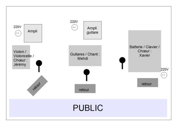
Une prise secteur pour les lumières doit être fournie sur la scène ou proche de celle-ci. Elle doit être si possible sur une ligne électrique différente des prises dédiées aux amplis.
